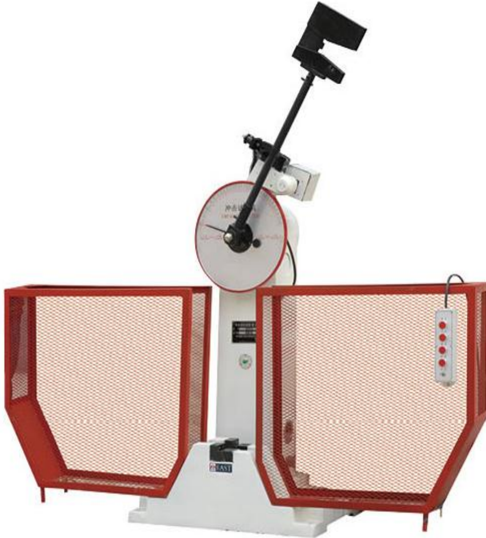
شكل (2-3) جهاز فحص الصدم
