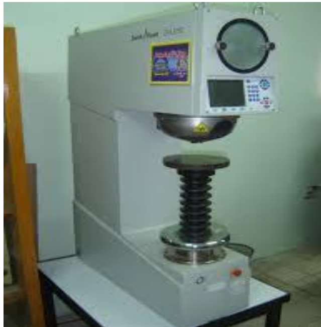
شكل (2-8) جهاز اختبار روكويل
